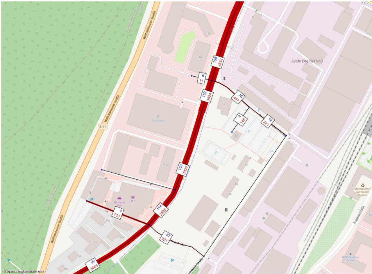
Abbildung 4: Durchschnittliche werktägliche Verkehrsbelastung Analyse 2020 [Kfz/24h, SV/24h]
