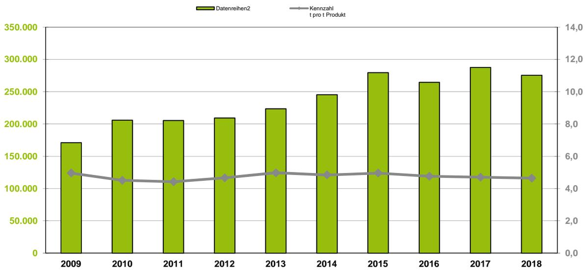
Für den technischen Einsatz als Prozesswasser wird das verwendete Kühlwasser im werkseigenen Kraftwerk über eine Ionentauscheranlage aufbereitet. Der Verbrauch an VE-Wasser (vollentsalztem Wasser) hängt direkt mit der Produktion zusammen und ist somit vom jeweiligen Produktionsmix abhängig.
